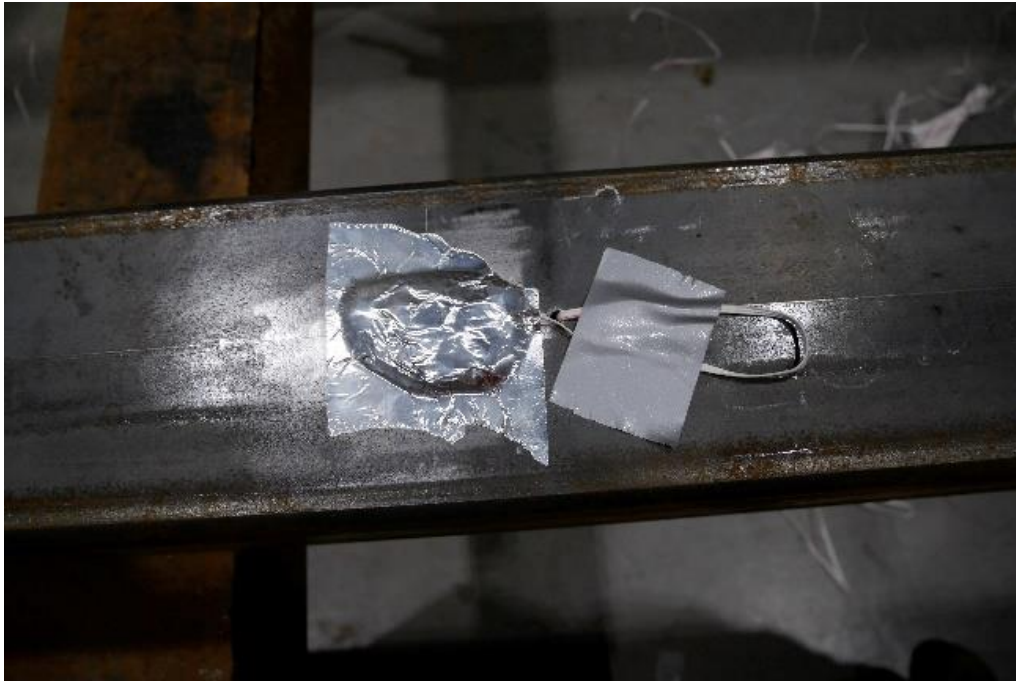
Figur 77: Töjningsgivare med dragen kabel, notera att kabeln inte täcks med aluminiumtejp
