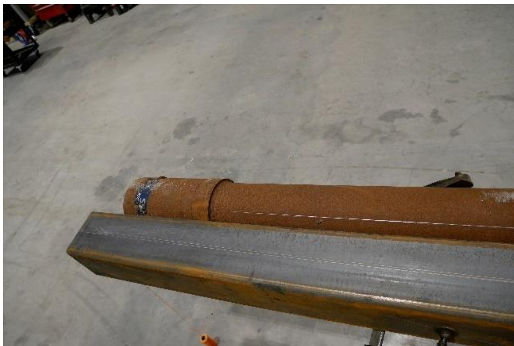
Figur 67: Spetsen på den cirkulära stålrörspålen utrustas med en pålsko
