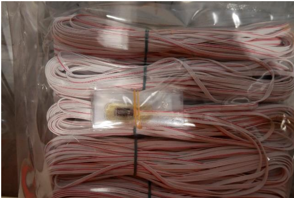
Figur 71: Skyddad töjningsgivare i förpackning
