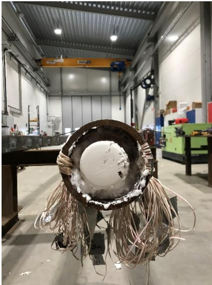
Figur 90: Påltopp fylls med fogskum
