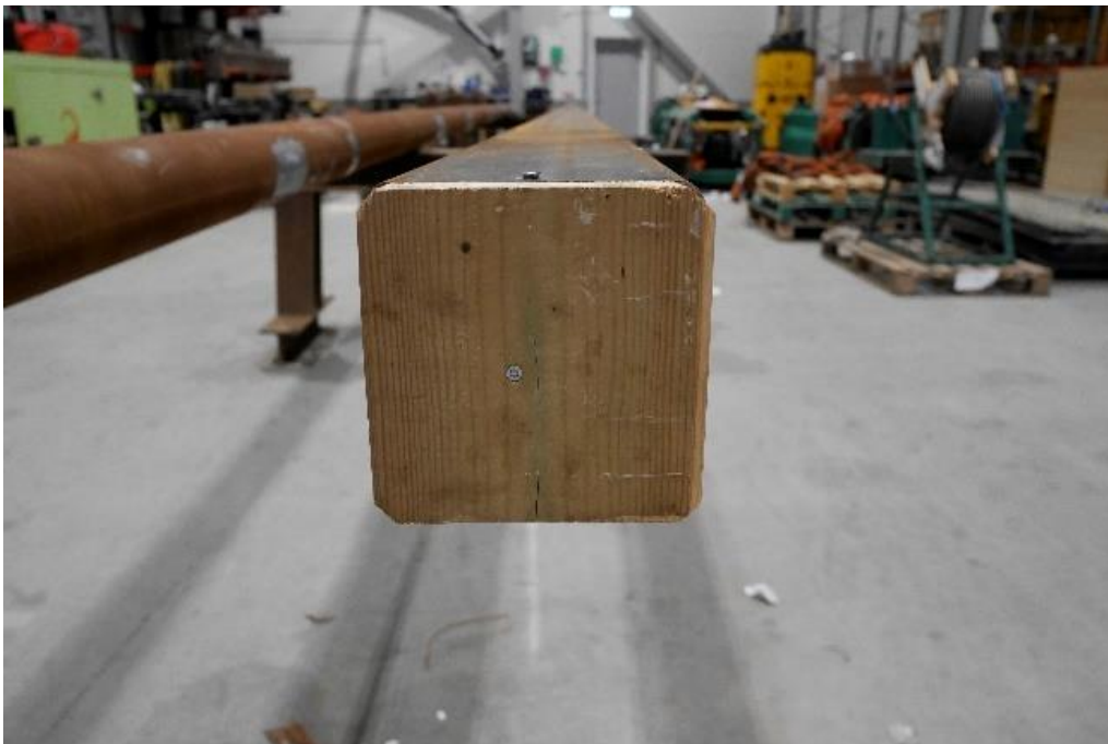
Figur 92: Plansko fästskruvad i VKR-påle
