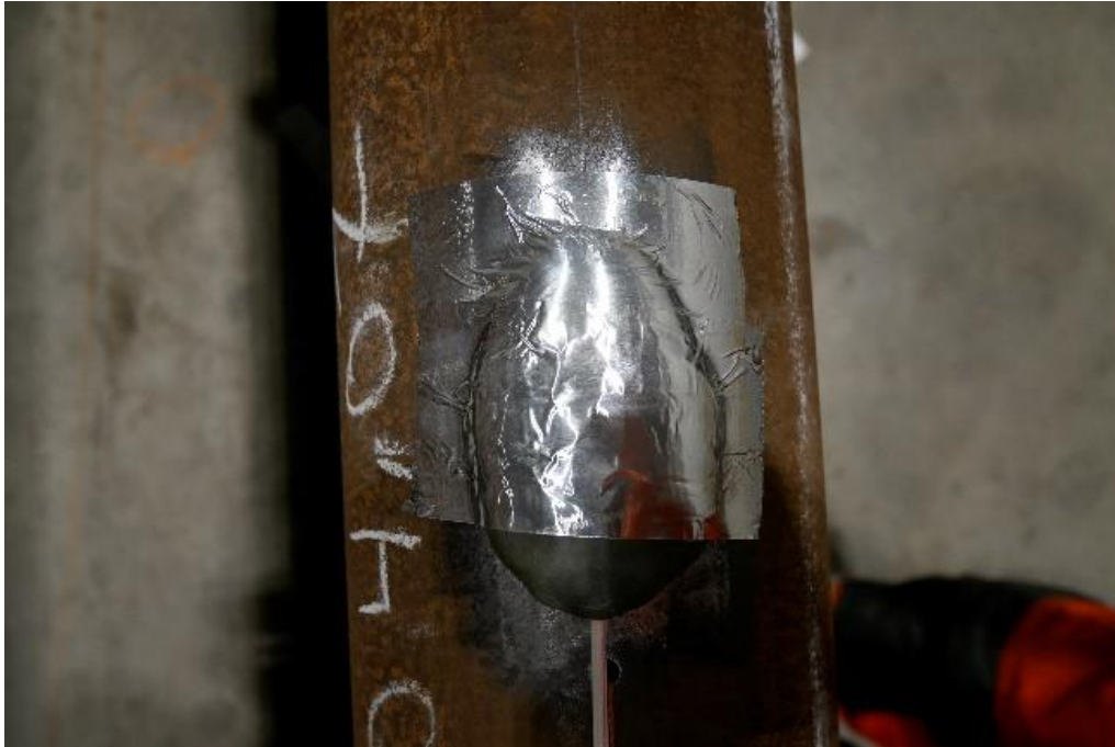
Figur 74: Givare som skyddats med aluminiumtejp
