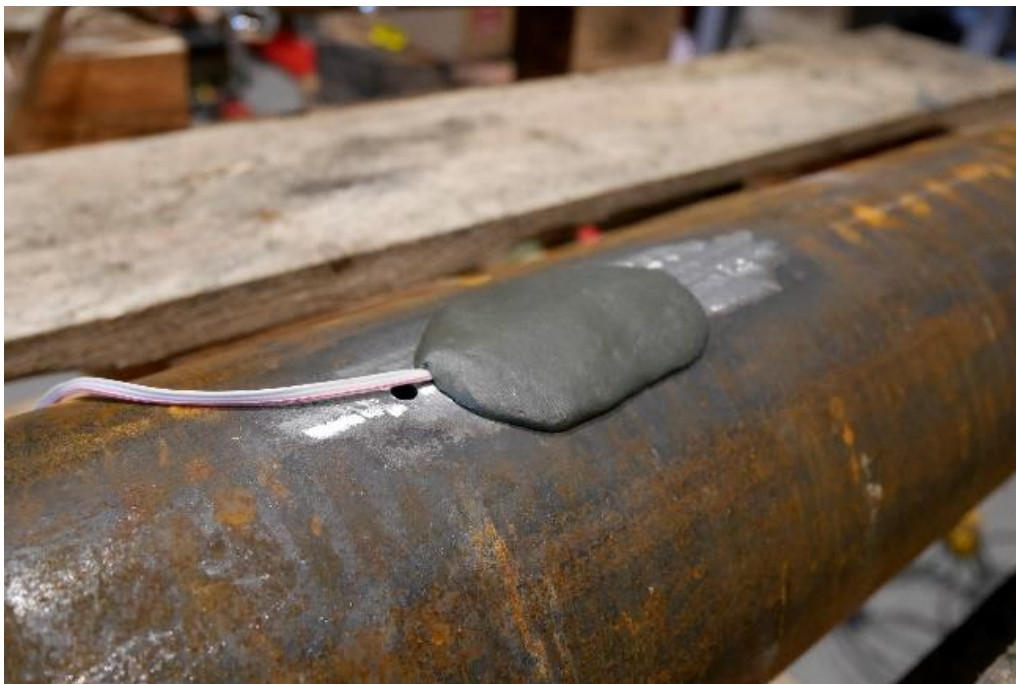
Figur 73: Givare som skyddats med AK-22
