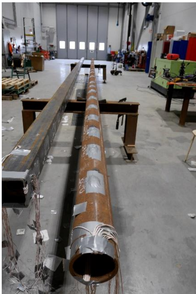
Figur 78: Cirkulär stålrörspåle med skyddade givare
