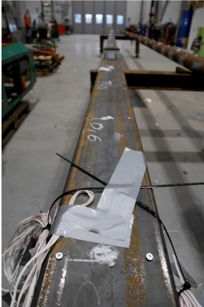
Figur 85: Centrerade hålen fylls med fogs-kum
