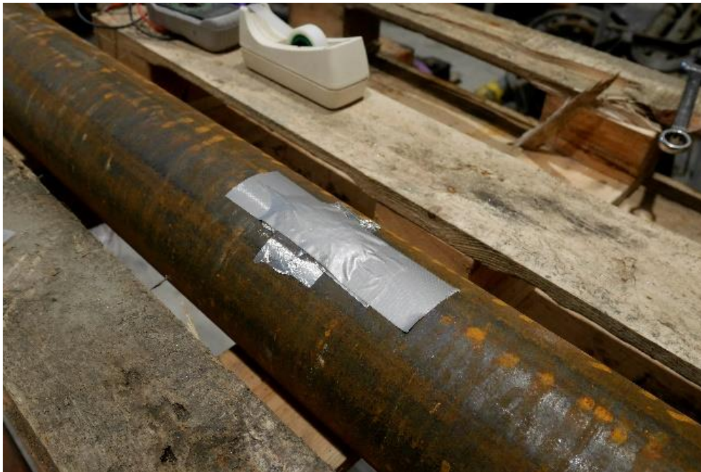
Figur 79: Limmad givare på provpåle
