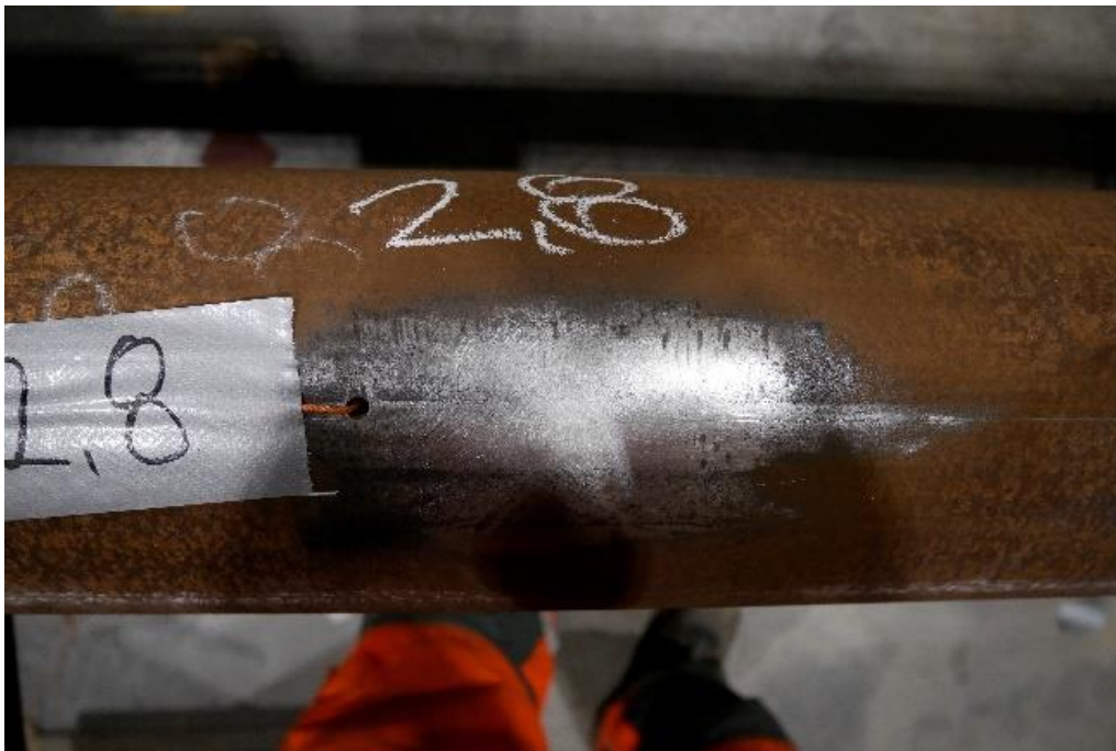
Figur 69: Slutgiltig yta för givare då slipning är utförd. I figuren ses ytan för givare F 2,8-C
