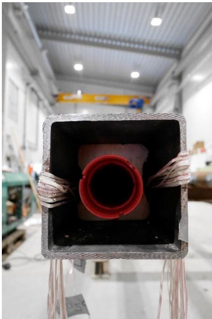
Figur 84: Inklinometer i VKR-påle
