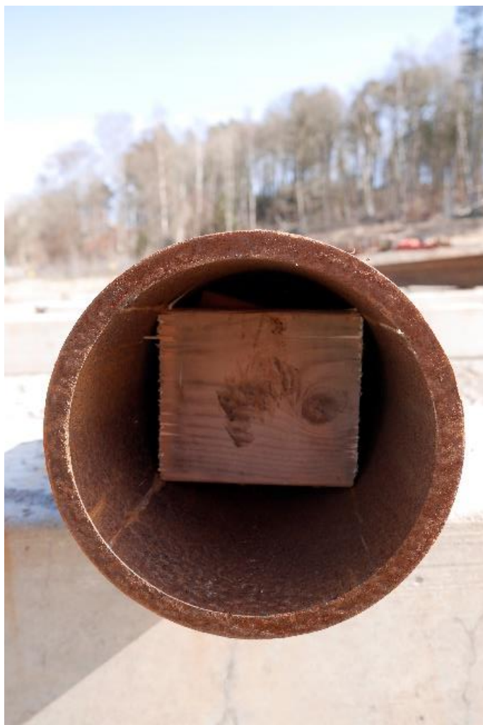
Figur 94: Fastkilade träplankor i cirkulär stålrörspåle utan givare
