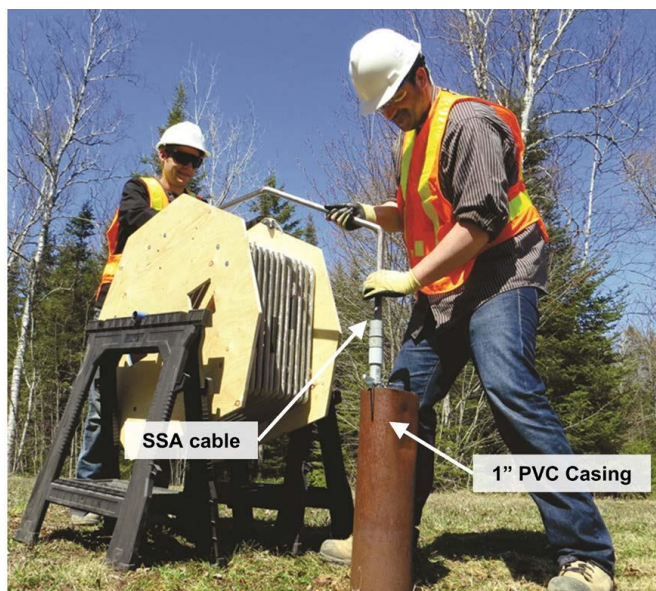
Figur 64: Mätning med SSA i stålrör (Hannigan et al., 2016)
