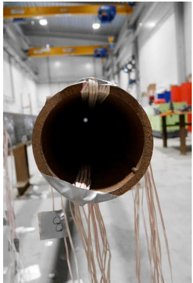
Figur 76: Ordning på kablar från cirkulära stålörspåle
